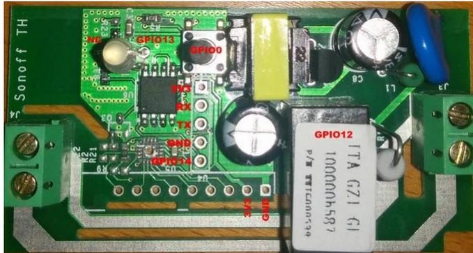
Figura B. 1. Interior de Sonoff Basic, con conexiones.
