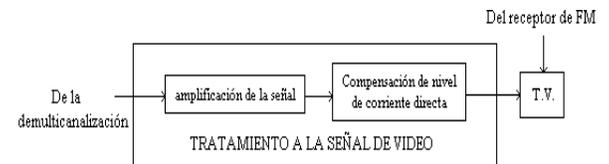
FIG. 12 BLOQUE DEL TRATAMIENTO A LA SEÑAL DE VIDEO DEL RECEPTOR.
