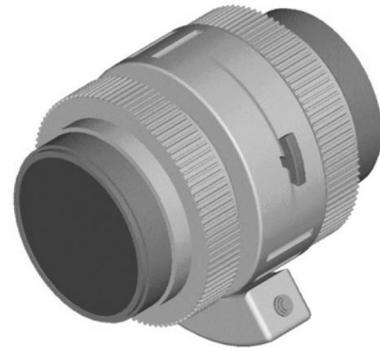
FIG. 23. VISTA ISOMÉTRICA DE LENTE OBJETIVO PROPUESTO CON LAS PARTES ENSAMBLADAS.
