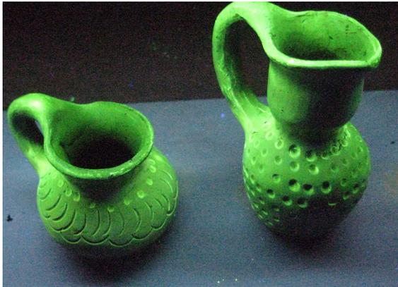
FIGURA 8. PIEZAS ARTESANALES CON PELÍCULA DE  $\text{Al}_2\text{O}_3:\text{Tb}^{3+}$  ESTIMULADAS CON LUZ-UV Y EXCITADAS A 302 NM
