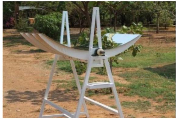
Figura 2. Prototipo de CCP.
