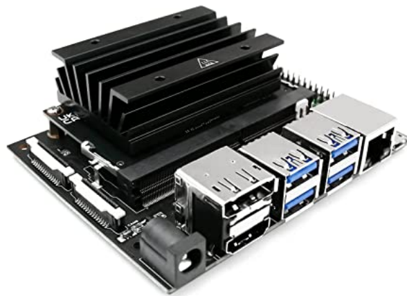
Figura 4.1: Computadora Jetson Nano
