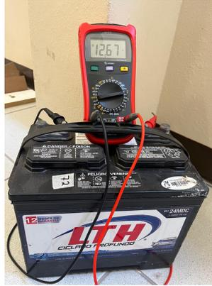
Figura 3.3: Voltaje de la batería en vacío.
