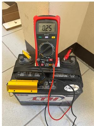
Figura 3.4: Corriente de la carga.
