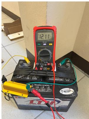
Figura 3.5: Voltaje de la batería con carga.
