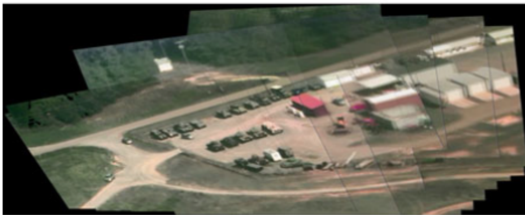
Figura 2.5: Los resultados muestra los detalles de unir dos imágenes basado en los feature maps obtenidos por el algoritmo SIFT y RANSAC para la eliminación de valores atípicos. Los resultados muestran que el método propuesto por Chen et al. (2017) es efectivo para hacer coincidir puntos, donde la mayoría de los puntos coincidentes son correctos. Algunos resultados típicos de unión de panoramas de imágenes de UAV muestran la efectividad del método propuesto.
