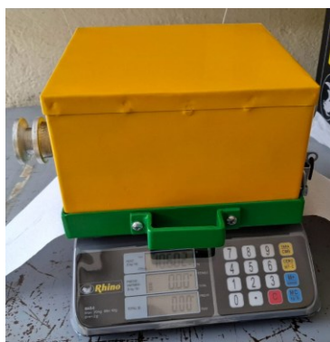
Figura 4.10. Peso total del prototipo de transmisión fabricado: 10.600 kg.
