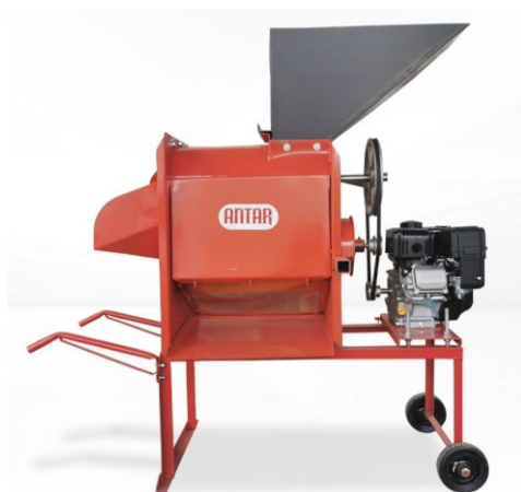
Figura 1.4. Desgranadora de maíz marca Antarix modelo 1800 [9].
