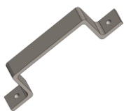
Figura 3.12. Asa fabricada con solera de 1/8" x 3/4".
