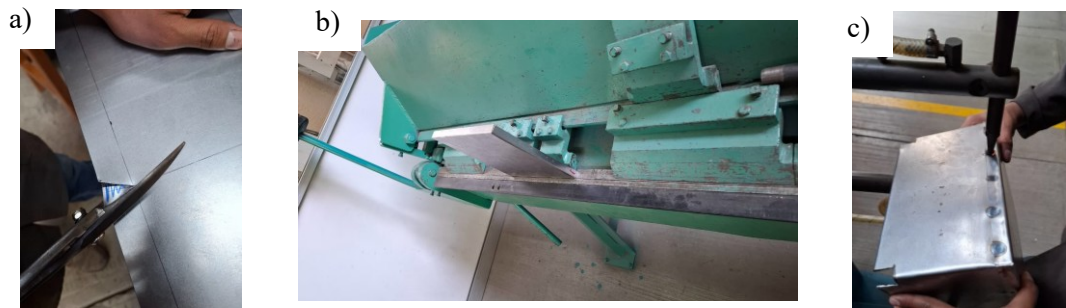
Figura 3.41. Fabricación de carcasa: a) corte de lámina, b) doblado de lámina y c) soldadura por puntos.
