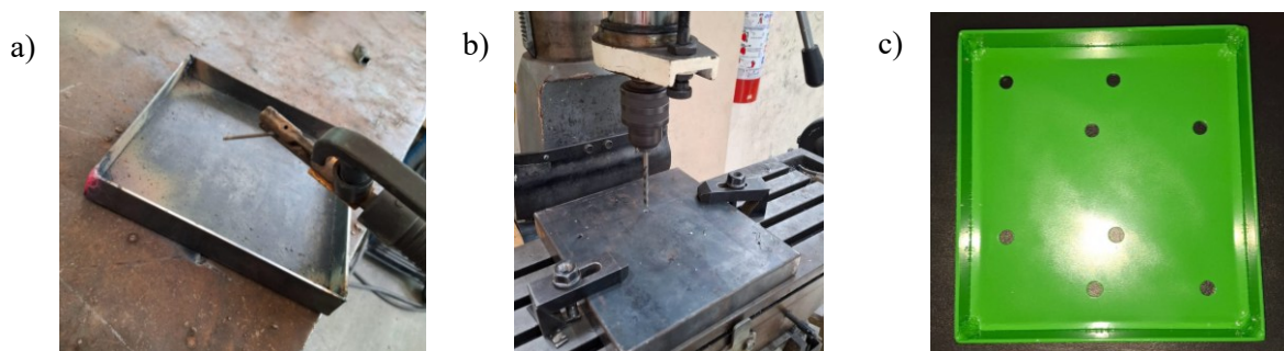
Figura 3.35. Manufactura de la base: a) doblado y soldado, b) barrenado y c) acabado final.
