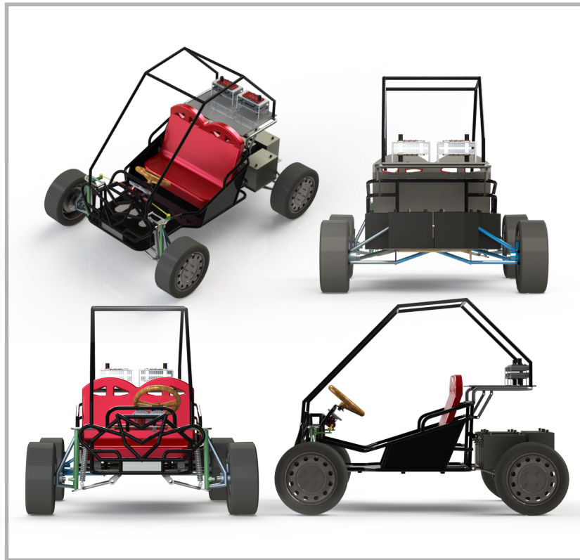
Figura 3.1: Vistas principales del vehículo eléctrico
