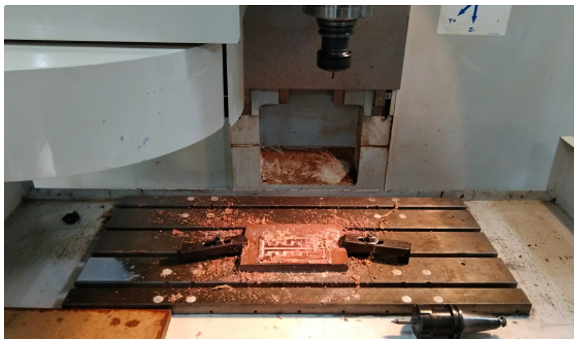
Figura 2.16: Maquinado de placa de cobre en CNC
