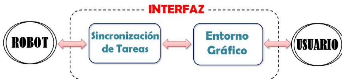
Figura 6.1: Diagrama de bloques del módulo de interfaz hombre-robot.
