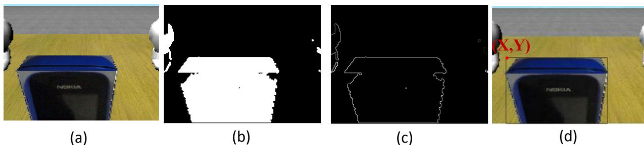
Figura 4.3: Función de procesamiento de imagen para la detección del objeto. (a) Imagen de entrada, (b) Binarización, (c) Detección de contornos, (d) Estimación de *BoundingBox* que lo contiene.
