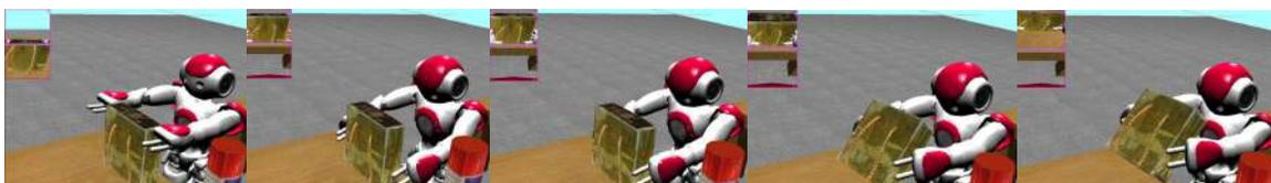
Figura 4.15: Secuencia de movimientos que realiza el robot NAO para tomar la bolsa.
