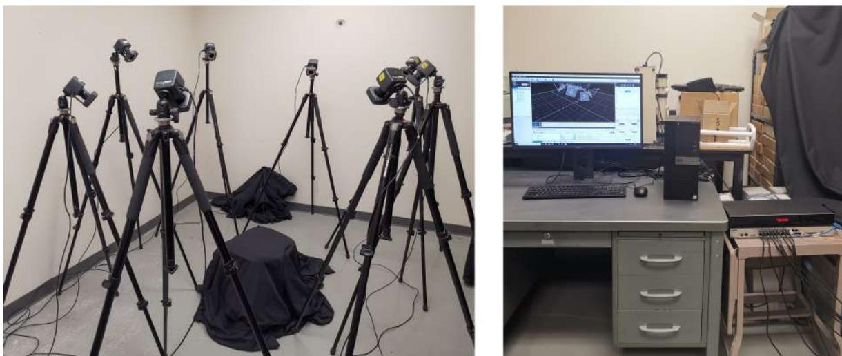
Figura 3.2: Sistema Vicon para captura de movimiento.
