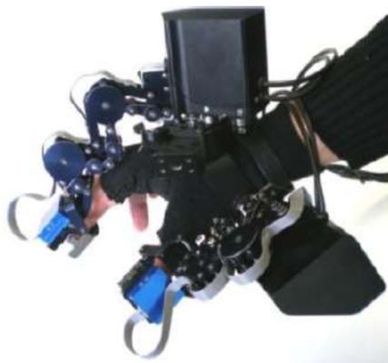
Figura 1.4: Exoesqueleto con mecanismo basado en centros remotos [22].
