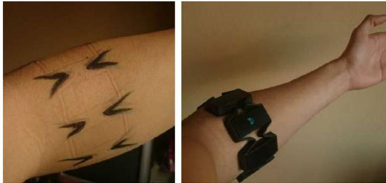
Figura 1.10: Problemas con la colocación de brazalete Myo.
