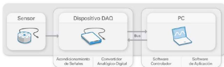
Figura 2.7: Partes de un sistema DAQ [55].
