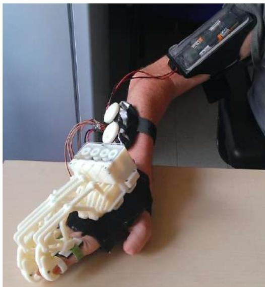
Figura 1.6: Prototipo de exoesqueleto diseñado con un sistema de captura de movimiento [24].
