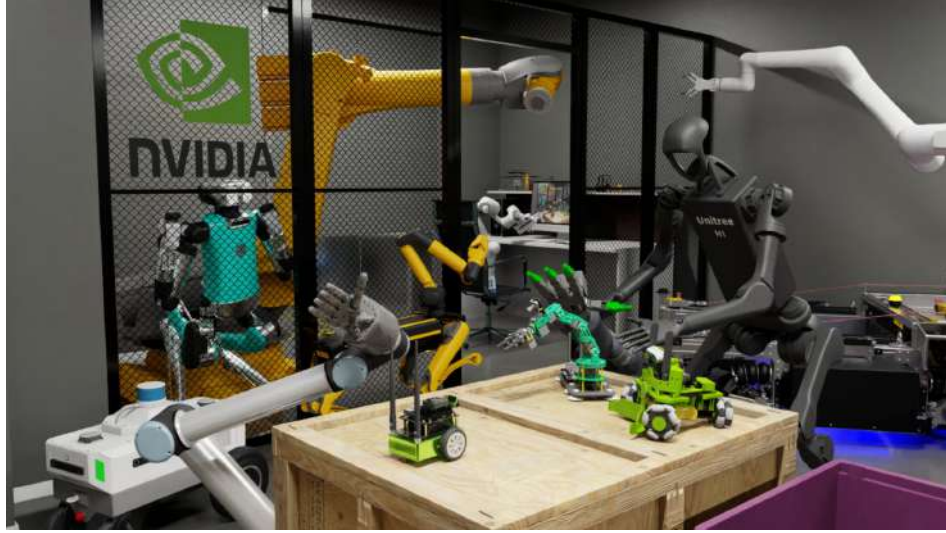
Figura 2.18: Entorno de simulación en Isaac Sim para pruebas de locomoción y control de robots [44].
