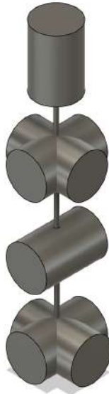
Figura 3.1: Modelo funcional para una pierna comúnmente utilizado para robots bípedos de 12 grados de libertad.
