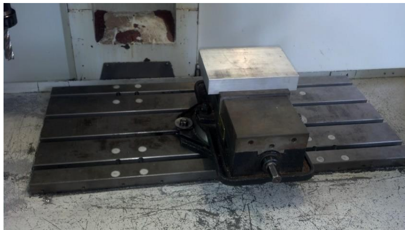
Figura 3.22. Sujeción del material a maquinar.
