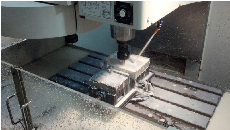
Figura 3.25. Remoción de material del depósito de agua.
