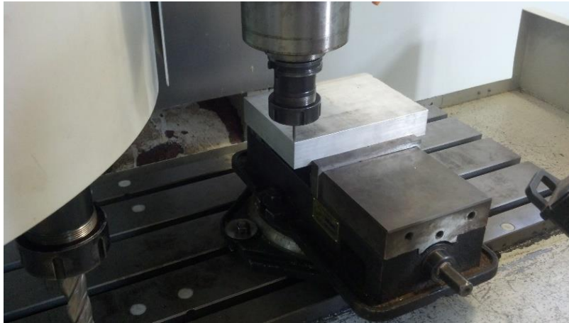
Figura 3.23. Ajuste del sistema de coordenadas para el origen de la pieza de trabajo.
