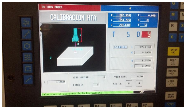
Figura 3.24. Calibración de herramientas en la fresadora CNC.
