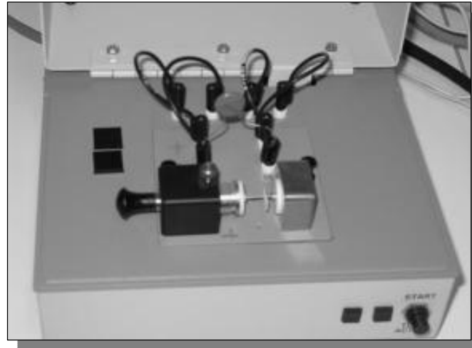
Fig. 47 Sistema de medición bajo prueba en LCR
