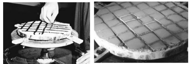
FIGURA 4. FOTOGRAFÍAS DE LA HERRAMIENTA DE PULIDO HECHA DE CHAPOPOTE.
