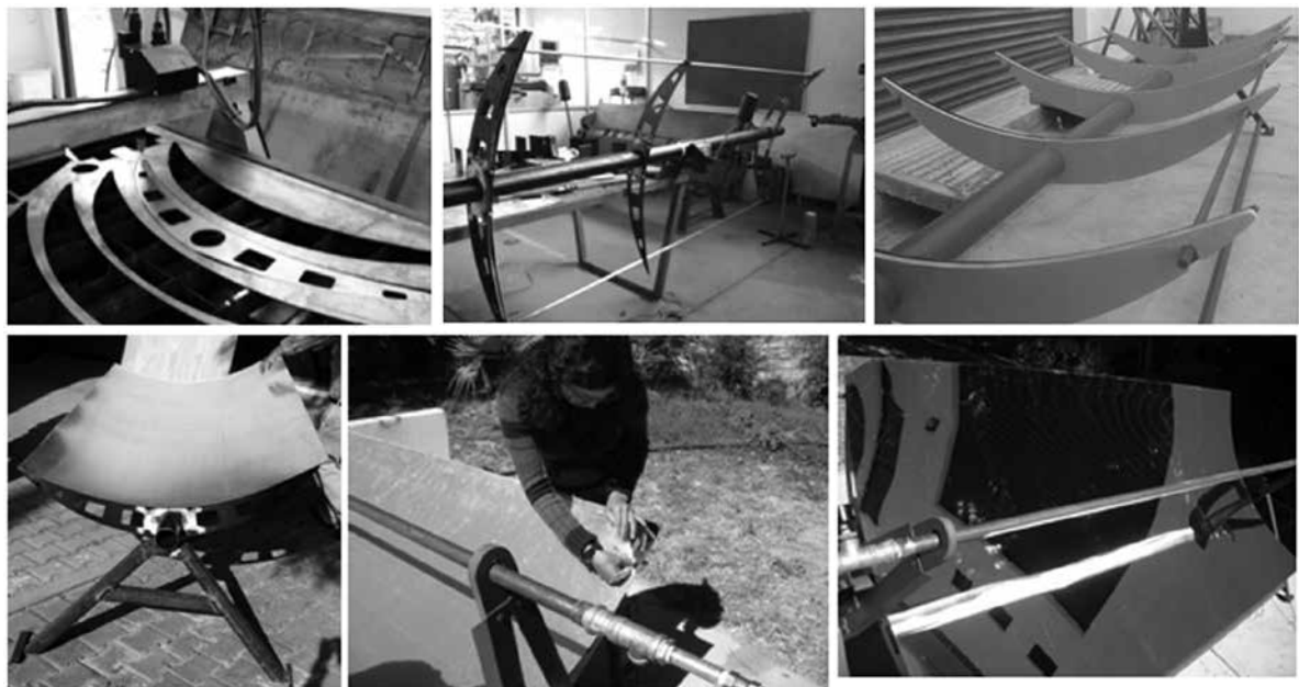
FIG. 10. ELABORACIÓN DE COMPONENTES MECÁNICOS: A) COSTILLAS EN ACERO, B) GUÍAS EN ACERO, C) COSTILLAS EN MDF D) SUPERFICIE REFLECTORA EN ACRÍLICO ACABADO ESPEJO, E) TUBO RECEPTOR EN COBRE Y F) UNIONES EN FIERRO
