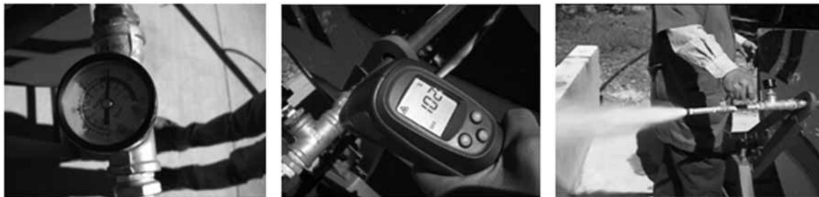
FIG. 12. PARÁMETROS MEDIDOS EXPERIMENTALMENTE: A) PRESIÓN, B) TEMPERATURA Y C) VAPOR GENERADO.
