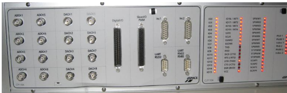
Figura 4.18: Conector para señales de entrada y salida del dSPACE.
