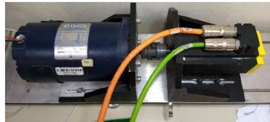
Figura 22. MSIP empleado (izquierda) y motor de CD usado como carga (derecha).
