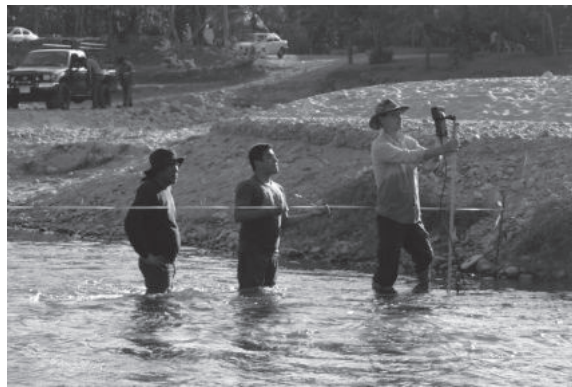
Figura 2. Medición del caudal mediante correntómetro portátil del río Copalita (17 de febrero de 2020).
