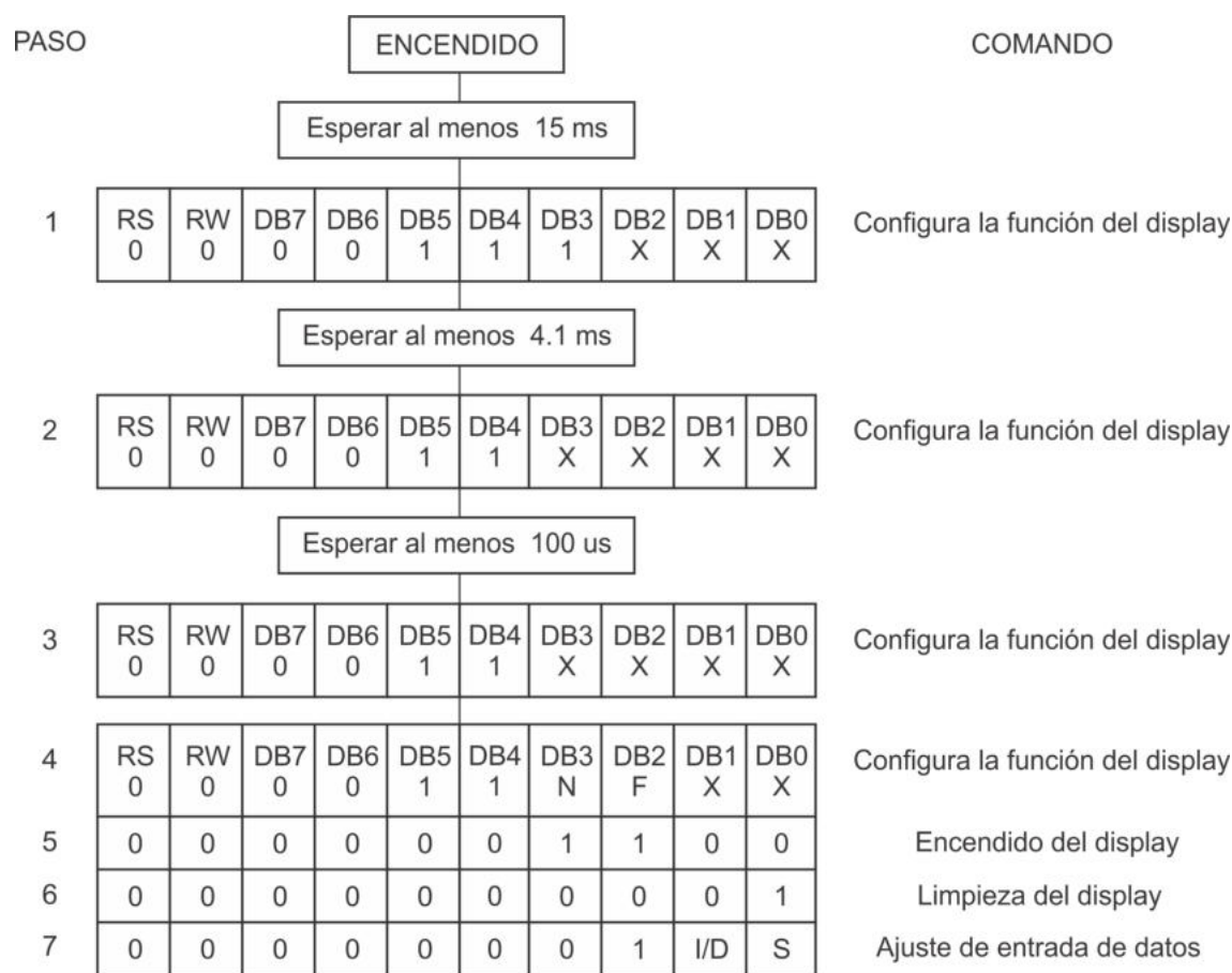
Figura 10.22: Secuencia para inicializar un LCD con una interfaz de 8 bits
