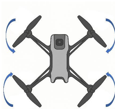
Figura 3.15 Sentidos de giro de los motores del UAV Parrot Mambo FPV.
