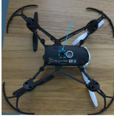
Figura 3.11 Sensor óptico del UAV Parrot Mambo.
