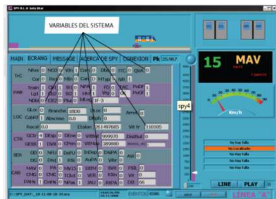
Figura 1.4: Interfaz gráfica del nuevo SPY y sus variables para diagnóstico de fallas.
