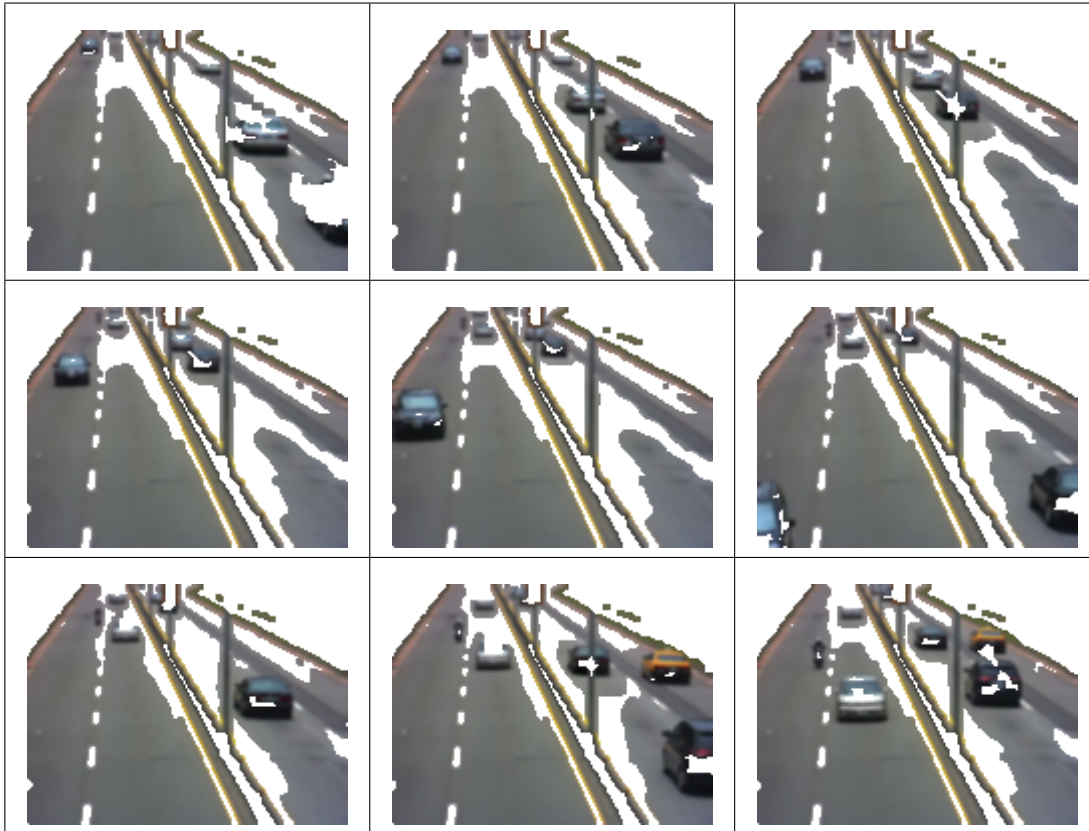
Figura 7.27: Video de control de trafico y 5 neuronas, resultados de agrupamiento del cluster 0.
