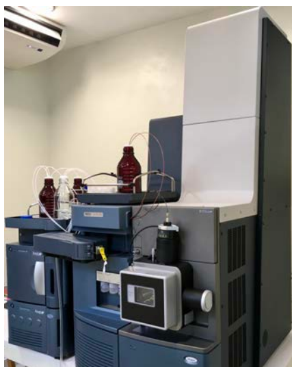
Figura 12. Equipo UHPLC-QToF, Laboratorio de Biotecnología, UTM.
