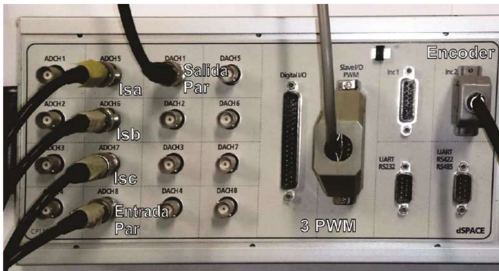
Figura 6.8: Conexiones de entrada y salida en el dSPACE CLP1104.
