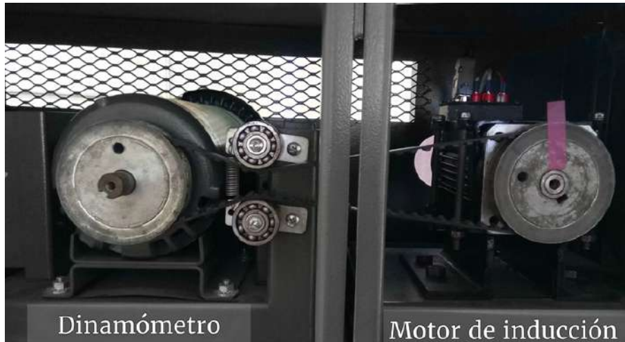
Figura 6.6: Motor de inducción acoplado al dinamómetro de par de carga.
