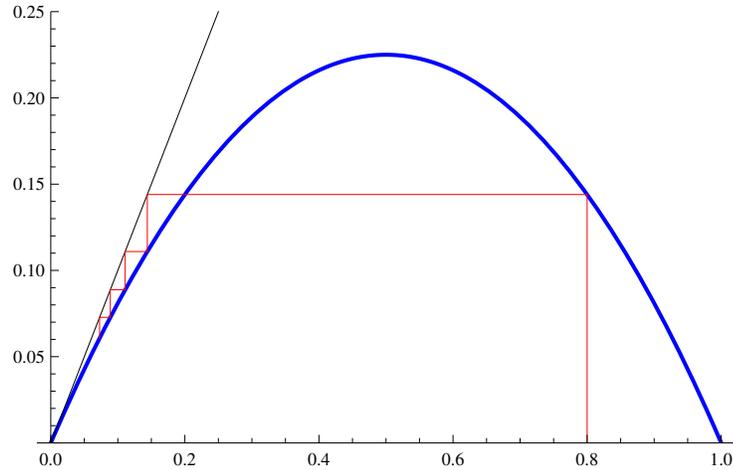
Figura 2.16: Diagrama Cobweb de la función  $f_\lambda$ , donde  $0 < \lambda < 1$ . En este ejemplo se ha seleccionado a  $\lambda = 0.9$  y como punto inicial a  $x_0 = 0.8$ . Podemos observar que todos los  $x \in [0, 1]$  tienden hacia el punto atractor  $x_c = 0$ .
