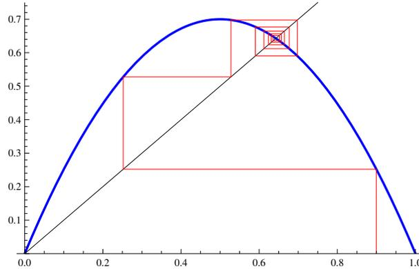
Figura 2.18: Diagrama Cobweb de la función  $f_\lambda$ , donde  $1 < \lambda < 3$ . En este ejemplo se ha seleccionado a  $\lambda = 2.8$  y como punto inicial a  $x_0 = 0.9$ . Podemos observar que todos los  $x \in (0, 1)$  tienden hacia el punto atractor  $x_\lambda = 0.64$ .
