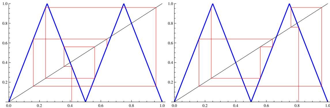
Figura 2.10: Diagrama Cobweb de la función  $T^2$ . En el primer diagrama, se ha elegido como punto inicial a  $x_0 = 0.41$  y en el segundo diagrama, el punto inicial es  $x_0 = 0.81$ . En ambos diagramas se observa que los puntos fijos de  $T^2$  son repulsivos.
