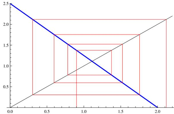
Figura 2.4: Diagrama Cobweb de la función  $f(x) = -\frac{5}{4}x + \frac{5}{2}$ , donde  $x_0 = 0.9$ .
