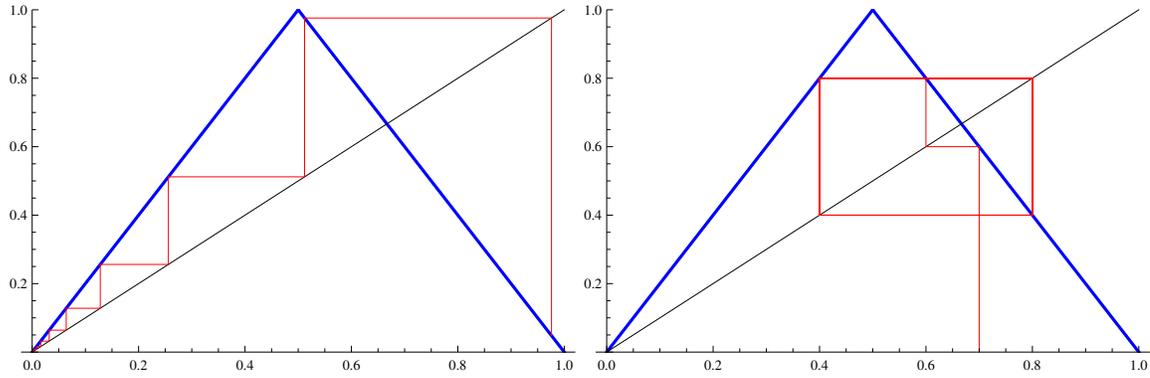
Figura 2.8: Diagrama Cobweb de la función Tienda. En el primer diagrama, se ha elegido como punto inicial a  $x_0 = 0.001$  y en el segundo diagrama, el punto inicial es  $x_0 = 0.7$ . En ambos diagramas se observa que los puntos fijos de  $T$  son repulsores.
