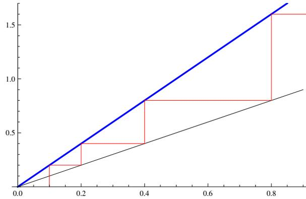
Figura 2.3: Diagrama Cobweb de la función  $f(x) = 2x$ , donde  $x_0 = 0.1$ .
