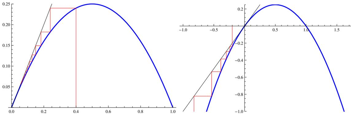
Figura 2.17: Diagrama Cobweb de la función  $f_\lambda$ , donde  $\lambda = 1$ . En el primer diagrama se ha seleccionado como punto inicial a  $x_0 = 0.4$ . Podemos observar que todos los  $x \in (0, 1)$  tienden hacia el punto fijo  $x_c = 0$ . En el segundo diagrama se ha seleccionado como punto inicial a  $x_0 = -0.2$ . Podemos observar que todos los  $x < 0$  son alejados del punto fijo  $x_c = 0$ . Por lo tanto,  $x_c$  es un punto fijo neutro.
