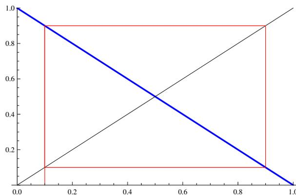
Figura 2.5: Diagrama Cobweb de la función  $f(x) = -x + 1$ , donde  $x_0 = 0.1$ .
