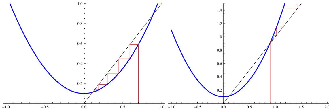
Figura 2.14: Gráfica de la función  $g_c$  con  $c < \frac{1}{4}$ . En el primer diagrama, podemos observar que todos los  $x \in (0, x_2)$  tienden hacia el punto fijo atractor  $x_1$ . En el segundo diagrama, podemos observar que todos los  $x > x_2$  son alejados del punto fijo repulsor  $x_2$ .
