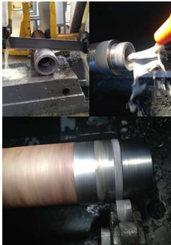
Figura 3.59: Manufactura de la tapa de la montura para lente PDMS
