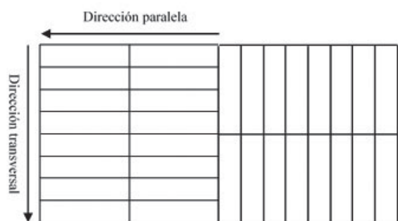
Figura 1. Recorte de probetas en los tableros de densidad media respecto al sentido de la línea de producción.
