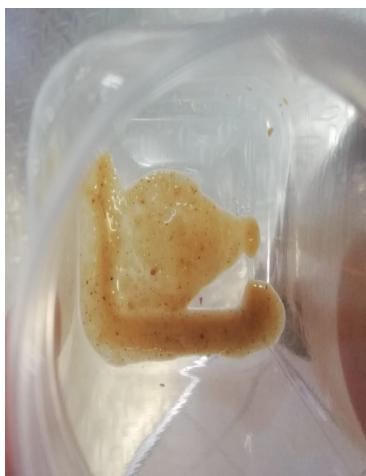
Figura 22. Resultado de un control inadecuado de temperatura en el prensado de semilla de cacahuate. A) Temperaturas inferiores a 80 °C; B) Temperaturas superiores a 80 °C.
