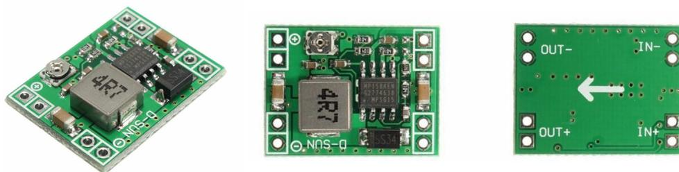
Figura 6.4: Convertidor de voltaje DC-DC Step-Down MP1584.
