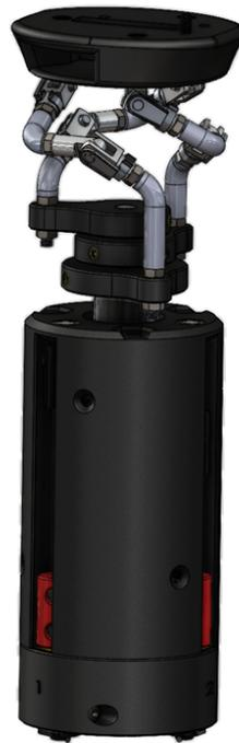
Figura 3.9: Sistema completo del mecanismo.
