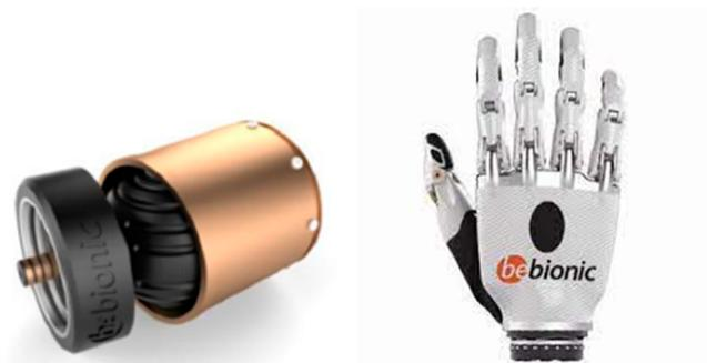
Figura 1.10: Mecanismo de muñeca Bebionic<sup>®</sup> [12].
