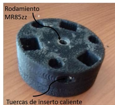
Figura 3.16: Soporte de motorreductores
