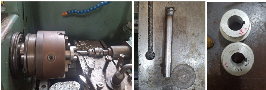
Figura 70. Acondicionamiento del acoplamiento.
