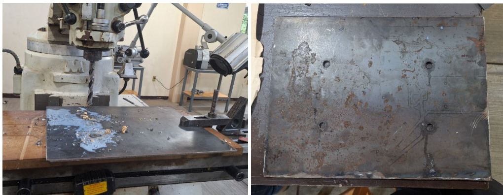
Figura 68. Perforado de placa.
