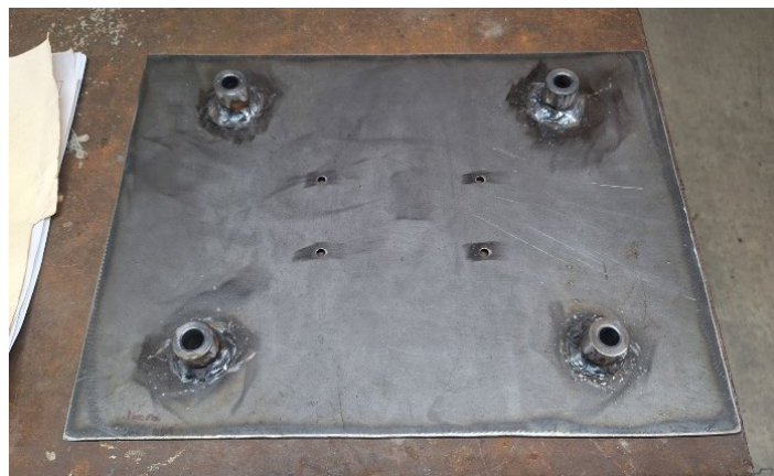
Figura 64. Bujes soldados a la placa.
