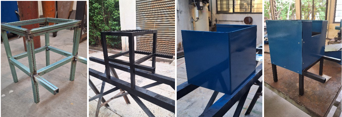
Figura 75. Fabricación de estructura de soporte.
