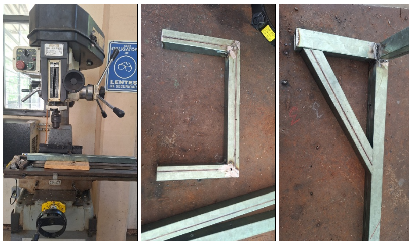
Figura 60. Proceso de taladrado, soldado y acabado.
