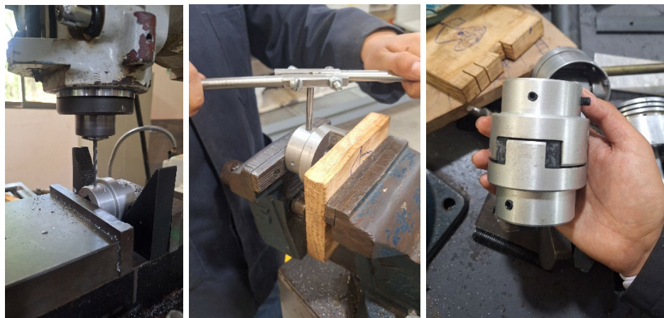
Figura 71. Taladrado y roscado para tornillos prisioneros.
