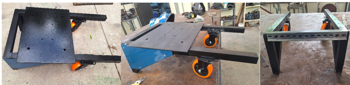
Figura 66. Proceso de pintado y remachado.
