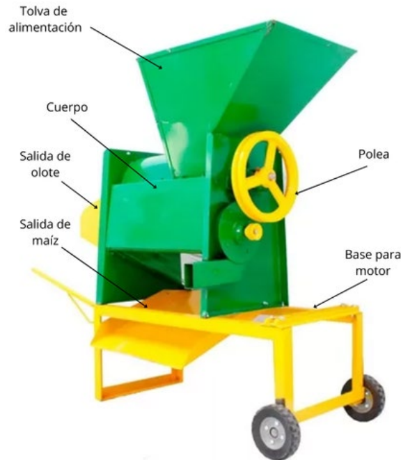
Figura 2. Partes de una desgranadora de maíz [15].
