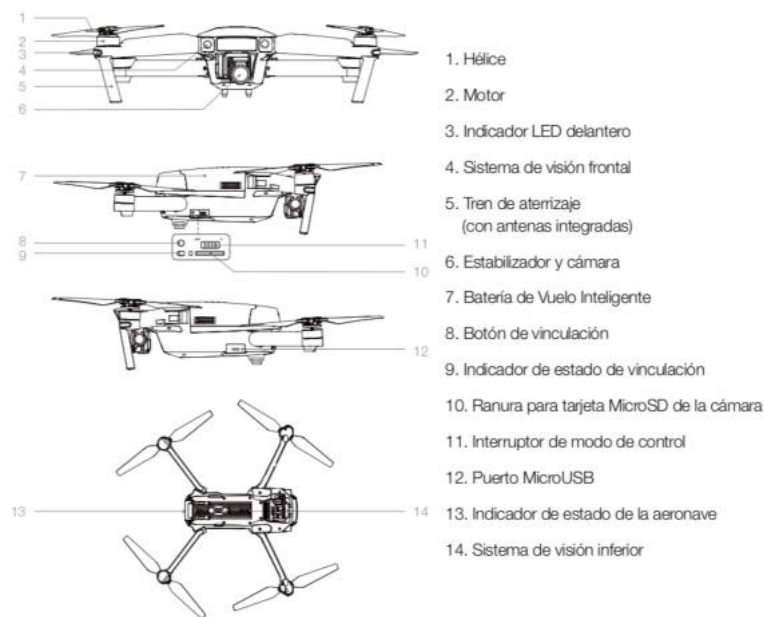
Figura 4.2: Características del DJI Mavic Pro. Se destaca la portabilidad de la aeronave y cámara de alta definición capaz de grabar video en 4K y capturar imágenes de 12 Megapíxeles.
