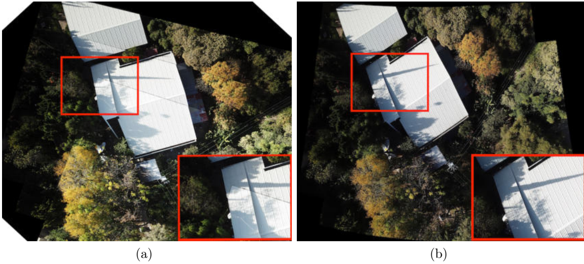
Figura 5.4: Aplicación del algoritmo GLC en el proceso de unión de imágenes. Al hacer zoom sobre una zona del resultado del stitching , se pudo observar, por un lado, la unión visible de las imágenes (ver Figura 5.4a) y la unión suavizada con la aplicación del GLC (ver Figura 5.4b)
