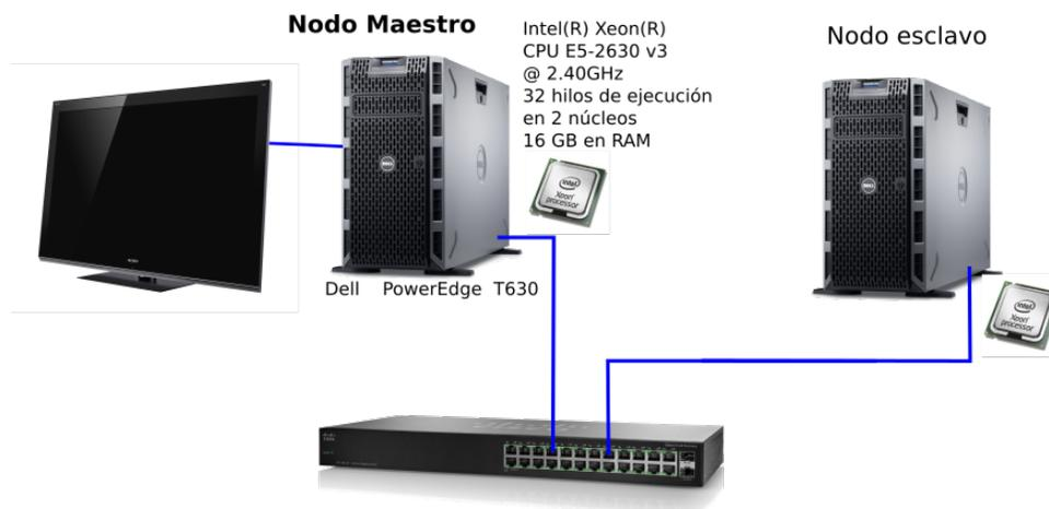
Figura 3.1: Elementos del clúster Beowulf usado para las pruebas.
